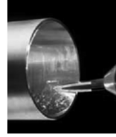
图 1：卡套管内径去毛刺
