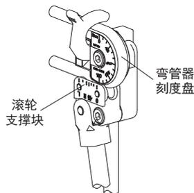
6. 完成折弯后，旋转短手柄使之与长手柄分离，并在滚轮支撑块上的0刻度大致与弯管器刻度盘上的 90° 刻线对齐时停下。松开短手柄与U形块之间的螺纹联接，旋转短手柄使其与长手柄平行，然后再将短手柄旋紧；
